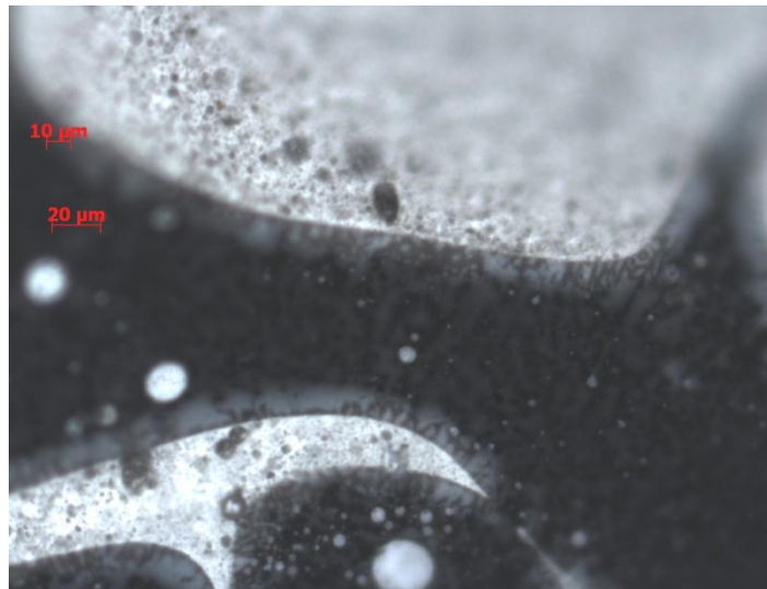
Figura 28. Imagen de la mezcla de asfalto-hule 15% m/m -polímero 10% m/m
