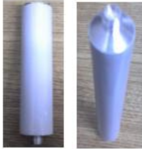
Figura 20. Tubos para prueba de segregación
