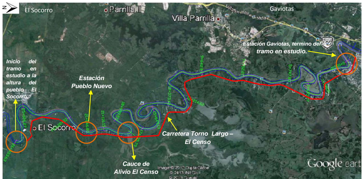
Figura 13. Planta del río de la Sierra del tramo en estudio, donde se presenta la ubicación de; estaciones hidroclimatológicas, estructura del cauce de alivio El Censo y en color rojo la carretera Torno Largo-El Censo. Fuente Google Earth.
