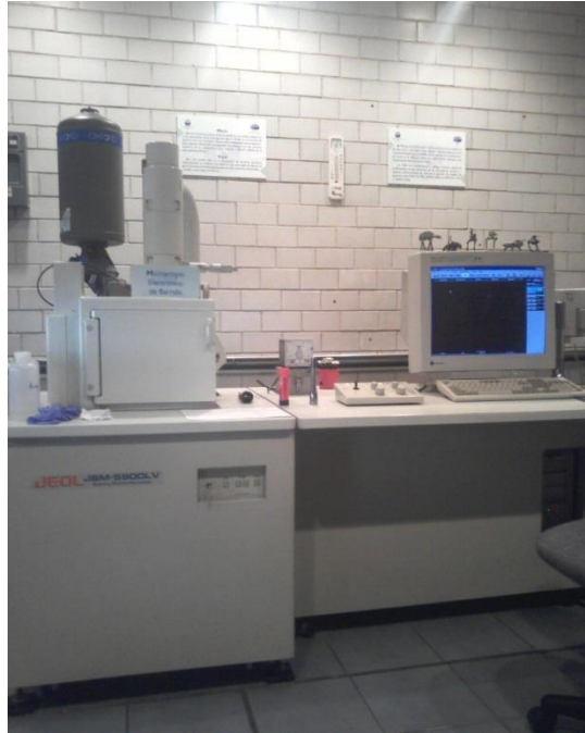
Figura A.3.1 Microscopio electrónico de barrido (JEOL, JSM-5900LV*).
