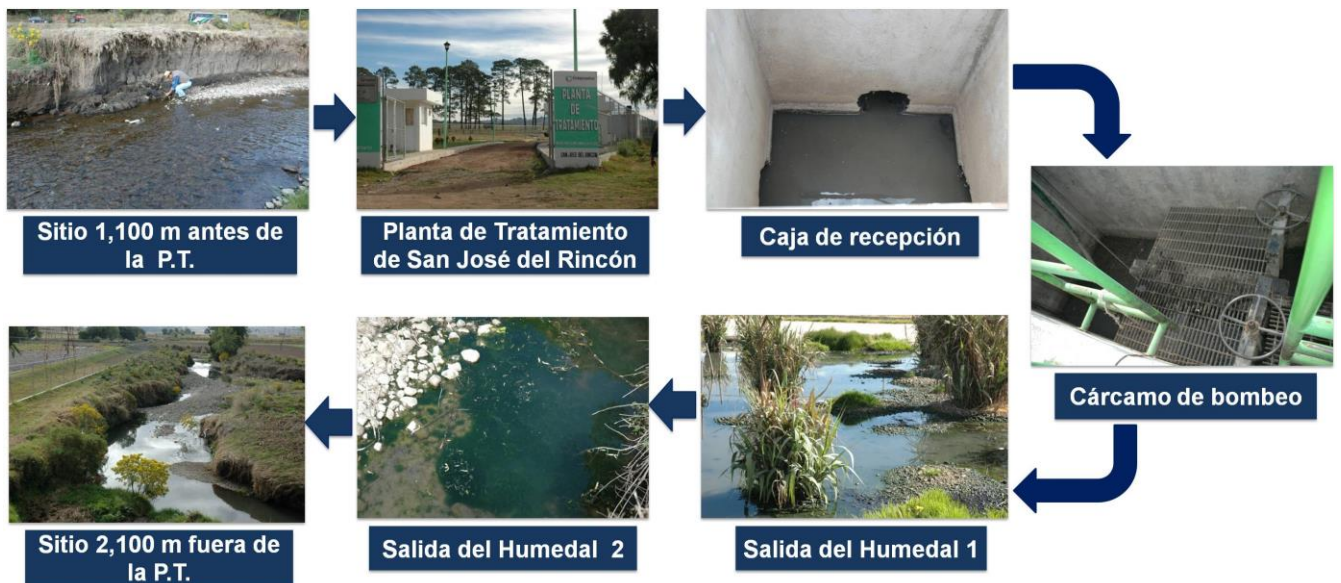
Figura 1. Diagrama de planta de tratamiento en San José del Rincón, Estado de México.
