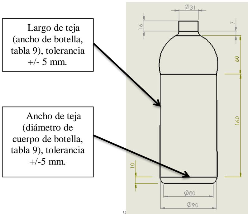
Figura 20.- Muestra las cotas de la botella de 1L marca bonafont de las cuales se tomaran las dimensiones de largo y ancho de la teja a fabricar (en milímetros).
