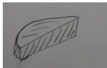
*Figuras 39 y 40 (izq. a der.).- Piezas curvas para generar el desplazamiento del sobrante hacia los contenedores y pieza para el re direccionamiento del cilindro posición vertical de nuestro sistema, correspondientemente.*
