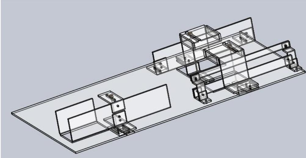
*Figura 52.- Vista isométrica de lado izquierdo del sistema para la fabricación de tejas a partir de botellas recicladas de PET.*
