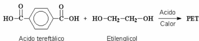
*Figura 2.- Proceso químico para la obtención de PET, mediante la condensación del etilenglicol y el ácido tereftálico (Torrice).*
