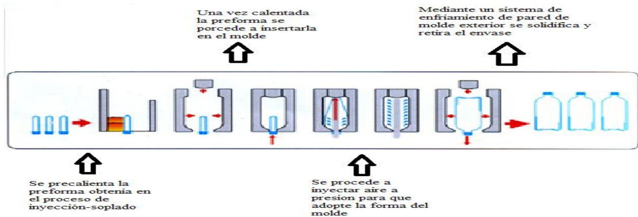
Figura 10.- Proceso de inyección-soplado-estirado en algunos polímeros como el PET resulta en un endurecimiento de la resina, que permite que las botellas resistan a la deformación bajo la presión que ejercen las bebidas carbonatadas (Chum power, 2006).
