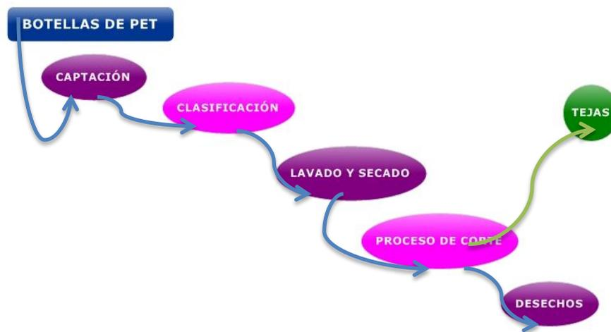
*Figura 24.- Muestra una alternativa (S1) en el proceso general para la obtención de tejas a partir de botellas recicladas de PET.*
