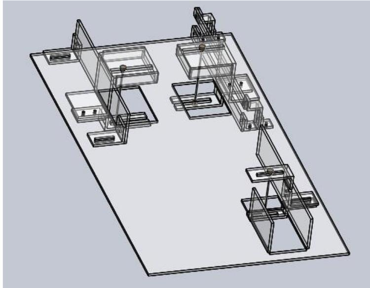
*Figura 51.- Ensamble en Solidworks 2010, partes que conforman el sistema de fabricación de tejas a partir de botellas recicladas de PET.*
