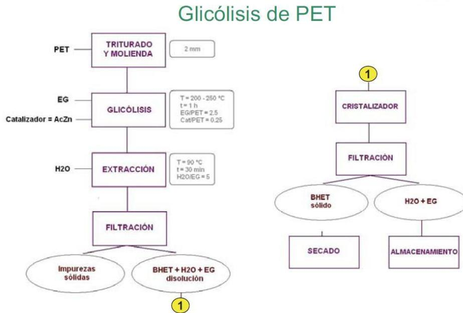
Figura 12.- Despolimerización del PET por glicólisis con etilenglicol (Tecnología, 2011).
