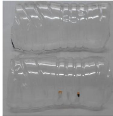
*Figuras 48 y 49 (izq. a der.).-Acabado dejado por el corte mediante Filamento Nichrom, pruebas 4-6*
