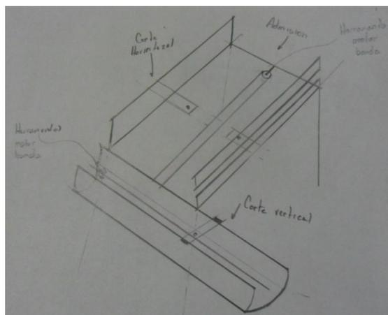
Figura 60.-Bosquejo del sistema de manera general para la obtención de tejas.
