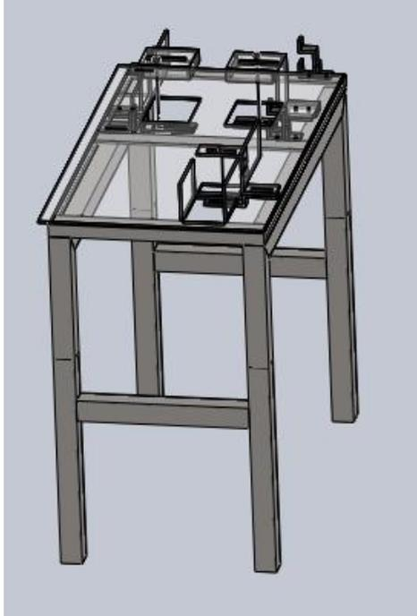
*Figura 55.-Ensamble en SolidWorks 2010 del sistema para la fabricación de tejas a partir de botellas recicladas de*
