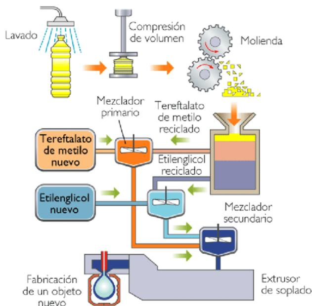
Figura 14.- Funcionamiento de una planta recicladora de PET, combinación de reciclado mecánico y químico, con un proceso de extrusión soplado para la reutilización del material (Kalipedia).
