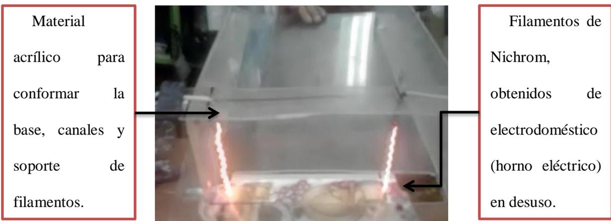
*Figura 45.-Modelo físico de la sección de corte del sistema para la fabricación de tejas a partir de botellas recicladas de PET.*
