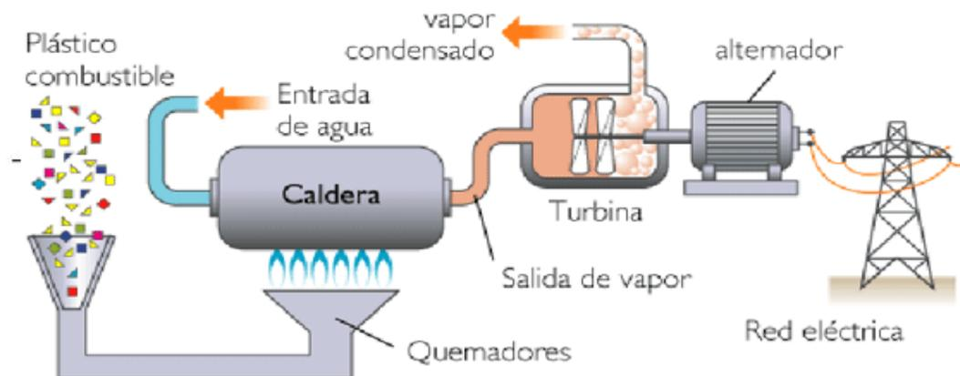
*Figura 13.- Proceso de reciclado energético, el PET se convierte en combustible para el funcionamiento de los calentadores que aumentan la temperatura del líquido (Kalipedia).*
