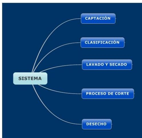
Figura 23.- Muestra los procesos con los cuales se planea cubrir la necesidad de tejas a partir de botellas recicladas de PET.
