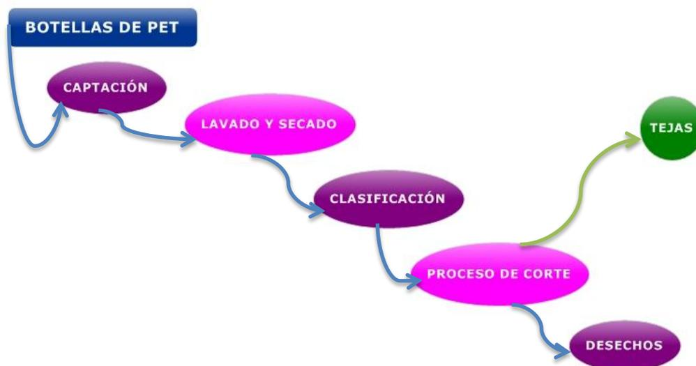
Figura 25.- Variante S2 del proceso general (sistema), en el cual el proceso de lavado y secado se encuentra antes que el de clasificación.
