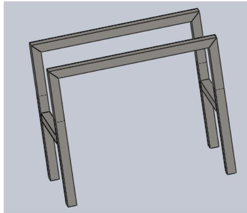
*Figuras 53 y 54 (izq. a der.).- Base para el sistema y estructura de soporte, correspondientemente.*
