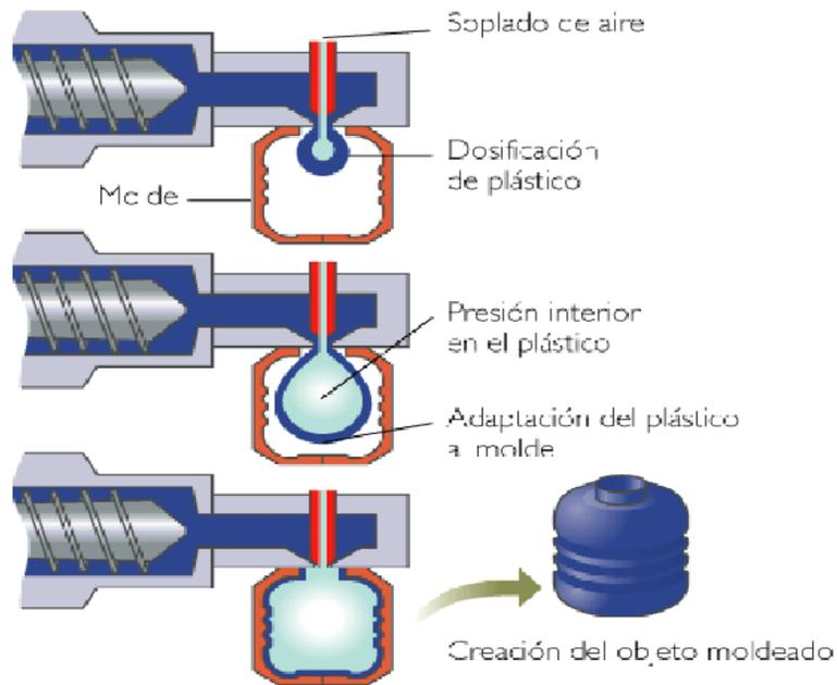
Figura 9.- Proceso de inyección soplado es un proceso para fabricar piezas de plástico huecas gracias a la expansión del material (Elisabeth, 2012).
