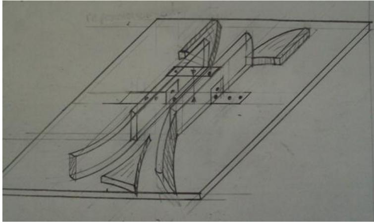
*Figura 43.- Etapa de re direccionamiento de material (vertical), corte (botella de manera vertical) y direccionamiento de sobrante hacia contenedores.*
