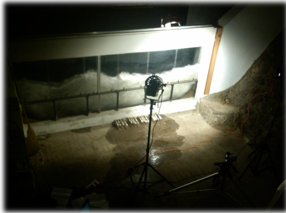
Figura 3.13 Ubicación de la instrumentación utilizada para el desarrollo de la técnica del BIV, en la primera parte del tanque.
