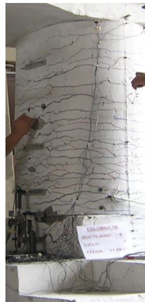
Figura 4.22. Daño en espécimen 1-B bajo control por desplazamientos. (a) Ductilidad 4, ciclo 1. (b) Ductilidad 6, ciclo 1
