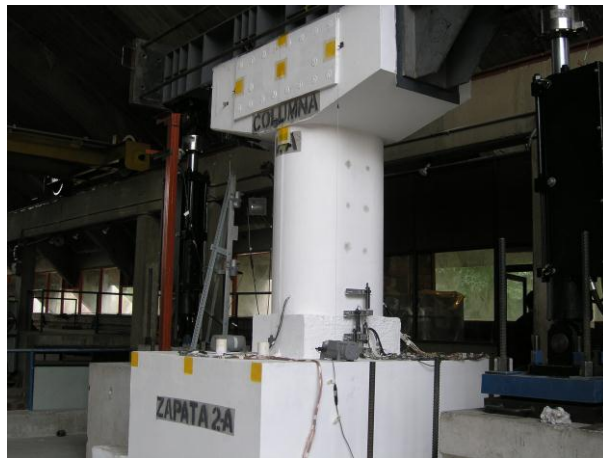
Figura 3.19 Espécimen 2-A al inicio de la prueba
