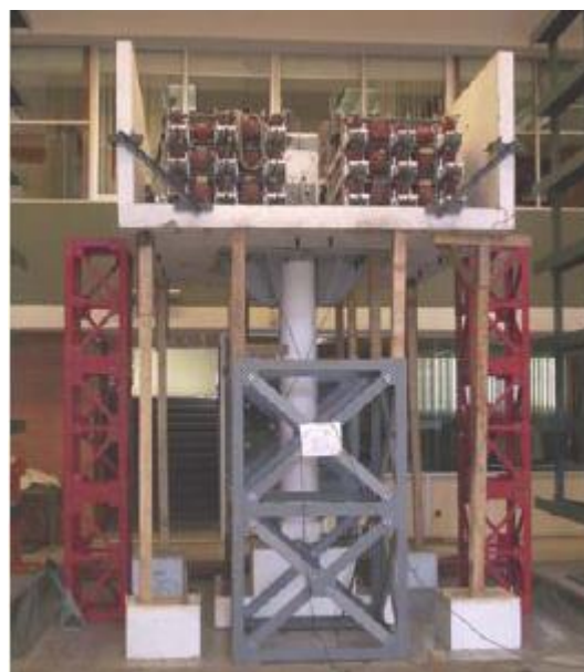
(b) Apuntalamiento final de la caja
