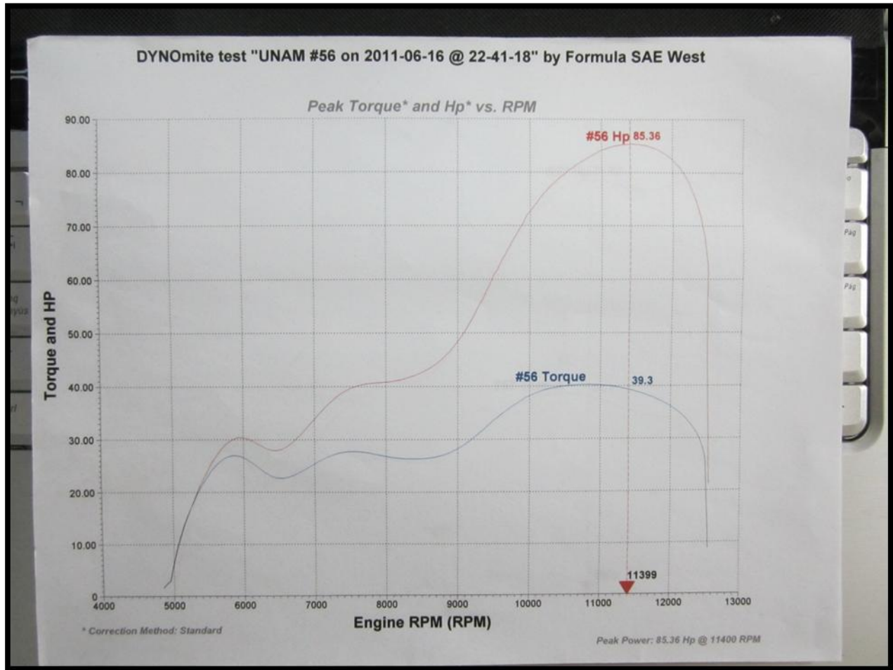
Fig. 7.1 Resultados en el dinamómetro de la competencia.
