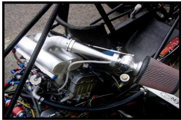
Fig. 3.2 Múltiple de admisión dual de aluminio
