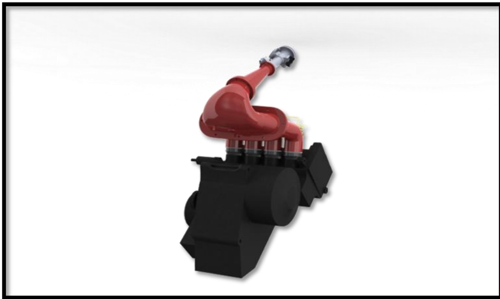
Fig. 3.12 Múltiple de admisión montado en el motor
