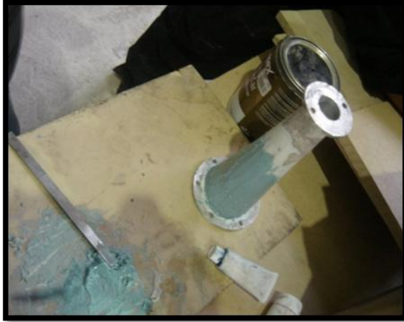
Fig. 3.7 Manufactura del difusor
