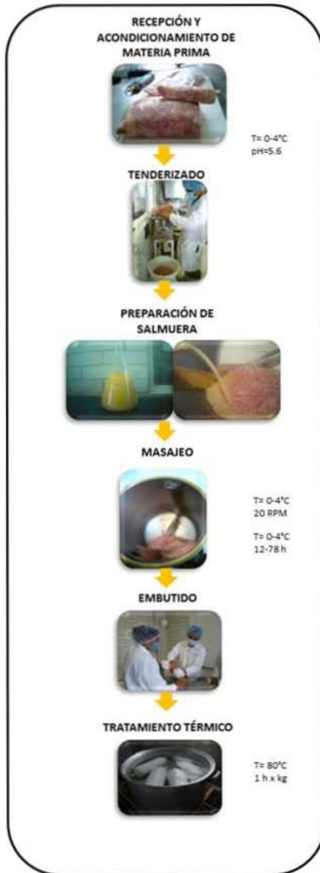
Figura 1. Diagrama de bloques ilustrado del proceso de elaboración de jamón de carne de conejo
