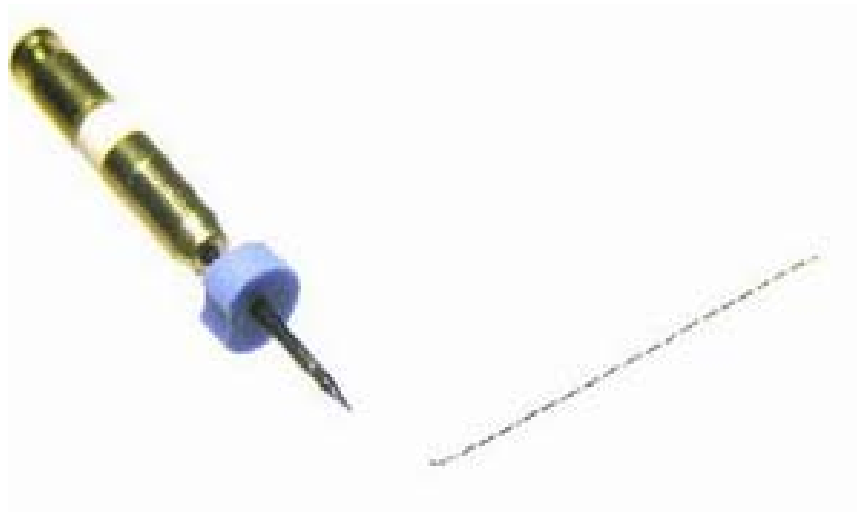
Figura 7.4 Fractura que presenta una lima rotatoria. 36
