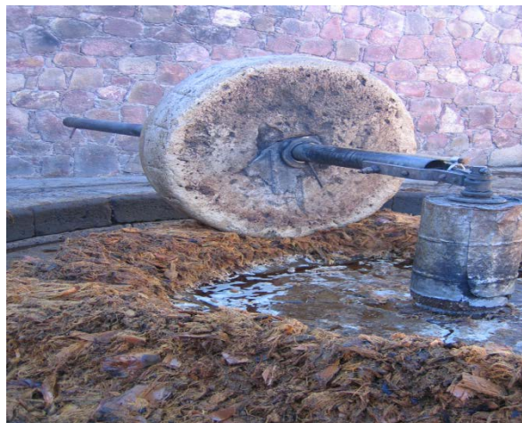
Figura 5.- Proceso de molienda en la tahona de las piñas de agave cocidas
