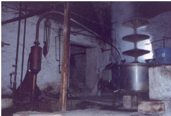
Figura 8.- Alambique de acero inoxidable en el que se lleva a cabo la destilación del mosto fermentado.
