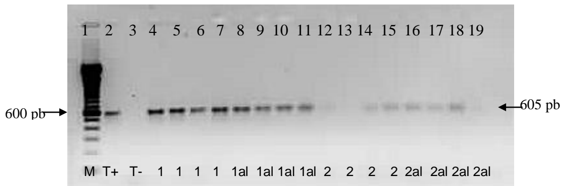
Fig. 36. PCR de experimentos en minitúnel de viento en presencia de múltiples hongos con los oligonucleótidos AB28 y TW81. El número indica el día y (al) indica uso de amortiguador de lisis.
