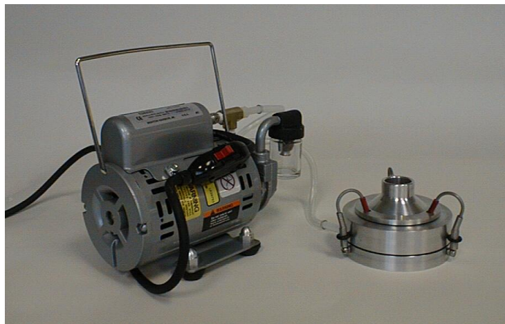
Fig. 28. Muestreador de partículas viables de un paso (Andersen).
