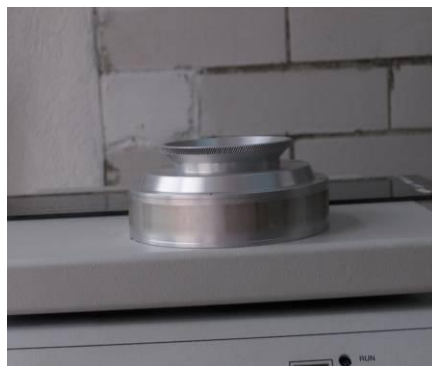
Fig. 26. Tambor interno de la Trampa de esporas Hirst.
