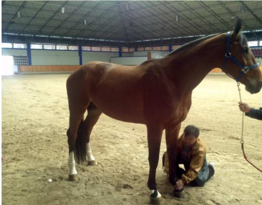
Figura 3. 6 Colocación de los acelerómetros para realizar la prueba de marcha.
