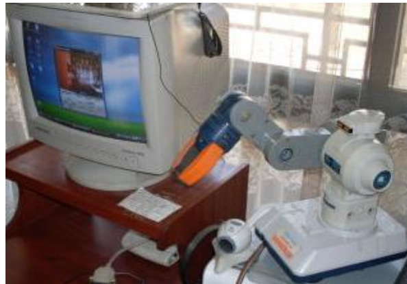
Figura 2.18 Robot MOBILE ARMATRON controlado por el puerto LPT de una PC.
