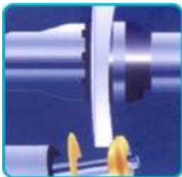
Ilustración 11- Proceso de Pulido de Lente Óptico, Fuente: Essilor Inc.
