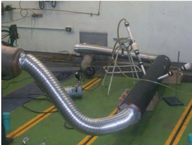
Figura 20. Túnel de dilución.
