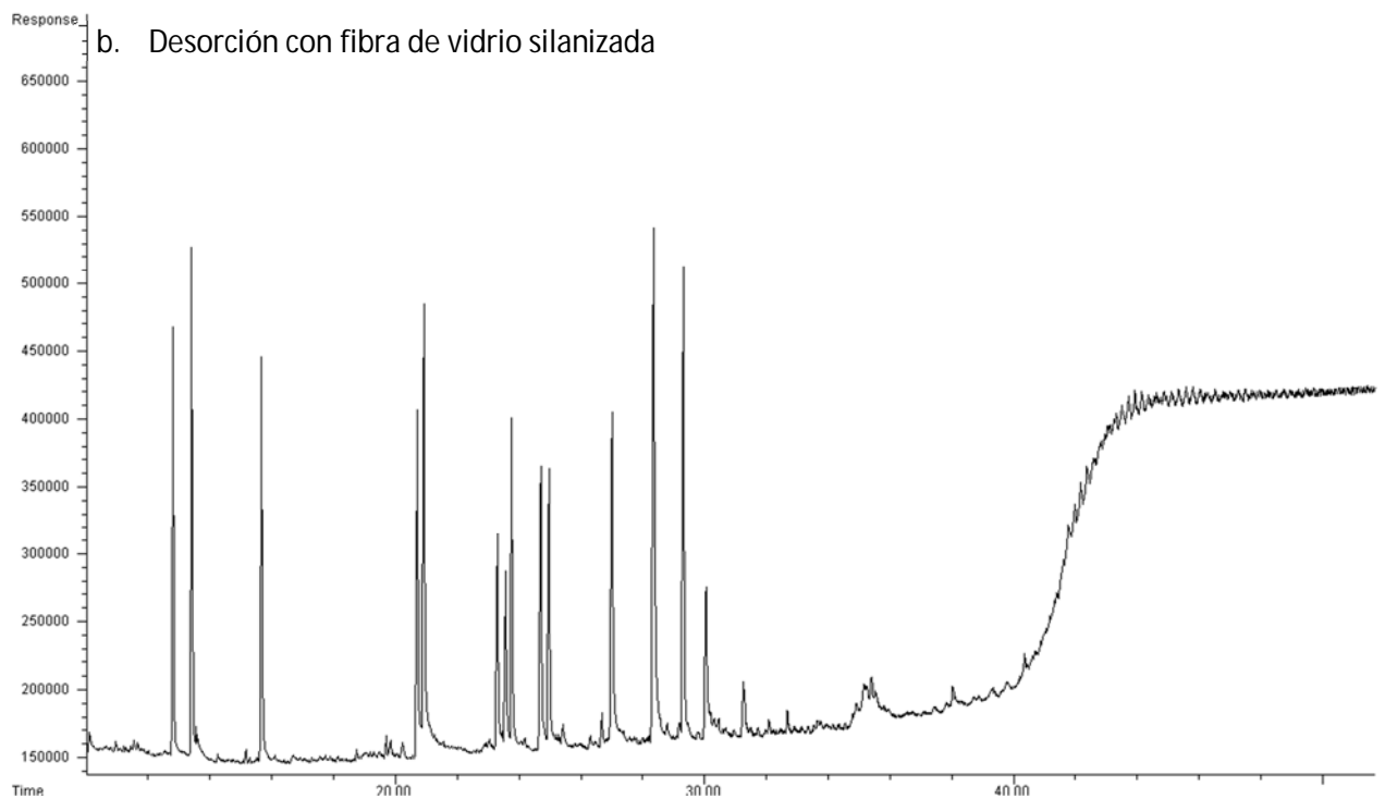
Figura 9. Evaluación de sorbentes para la desorción de HAP. a. desorción con carbograph 2 y b. desorción con fibra de vidrio.
