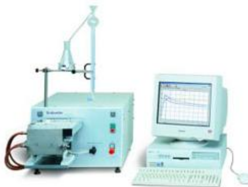
Figura 10. Farinógrafo para la determinación de propiedades reológicas en harinas.
