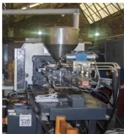
Figura 3.3 Inyectora utilizada marca DEMAG, ErgoTechPro 50-270, de 50 toneladas de fuerza de cierre.
