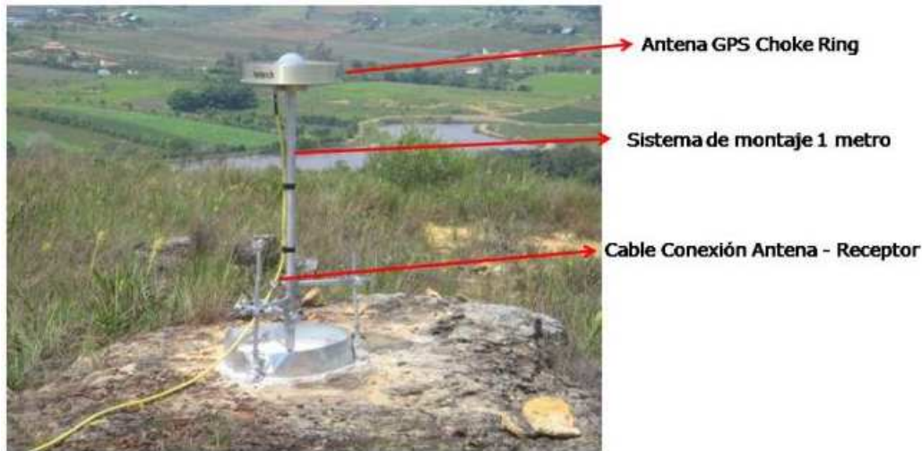
Figura 4.4: Monumentación tipo incrustación. Tomada de Campañas de campo con propósitos geodinámicos , página web del proyecto GEORED http://geored.ingeminas.gov.co/index.php/es/memorias-iii-taller-de-aplicaciones-cientificas-gnss-en-colombia .
