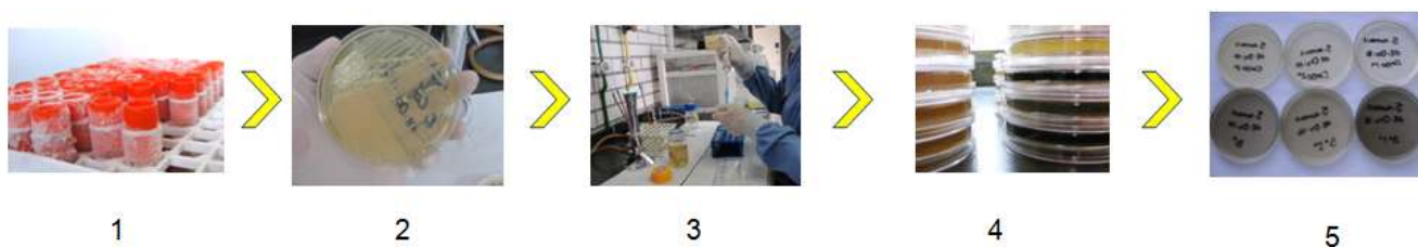
Figura 15. Ensayo de dispersión en agar. 1) Descongelado de la cepa bacteriana, 2) recolección de cultivos puros y obtención de D.O. = 1, 3) Dilución a 10 -3 , 4) Placas de agar TSA con NanoBi 0 y DMSO dispersos, 5) Observación de las placas después de ser inoculadas e incubadas durante 24hrs.
