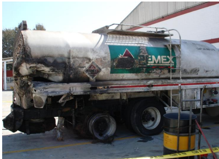
Figura 9. Autotanque perforado debido a una volcadura
