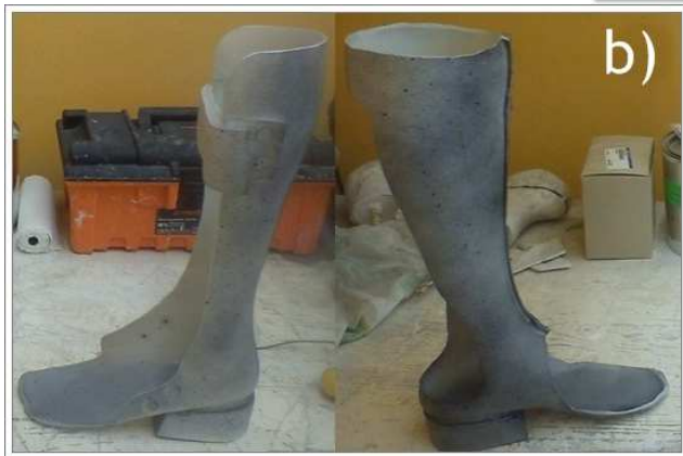
Figura 24. Preparación de ambos sistemas. a) Técnica de adherencia de puntos negros. b) y c) Superficies preparadas de puntos negros (F1y F2).
