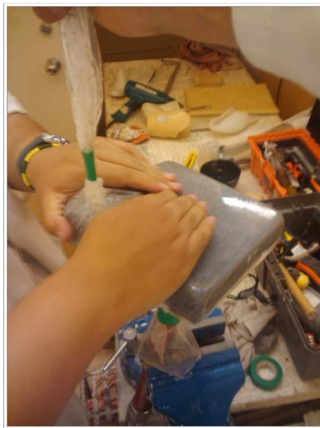
Figura 51. Vaciado e impregnación de la resina.
