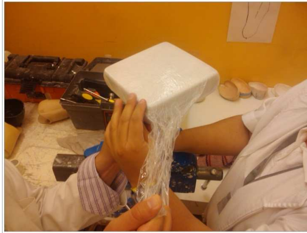
Figura 50. Colocación de la bolsa de PVA.
