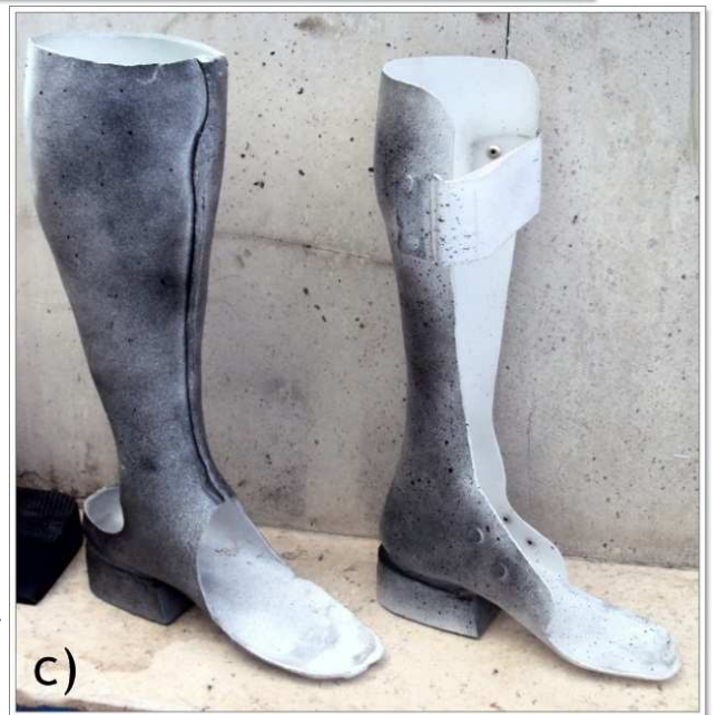
Figura 24. Preparación de ambos sistemas. a) Técnica de adherencia de puntos negros. b) y c) Superficies preparadas de puntos negros (F1y F2).
