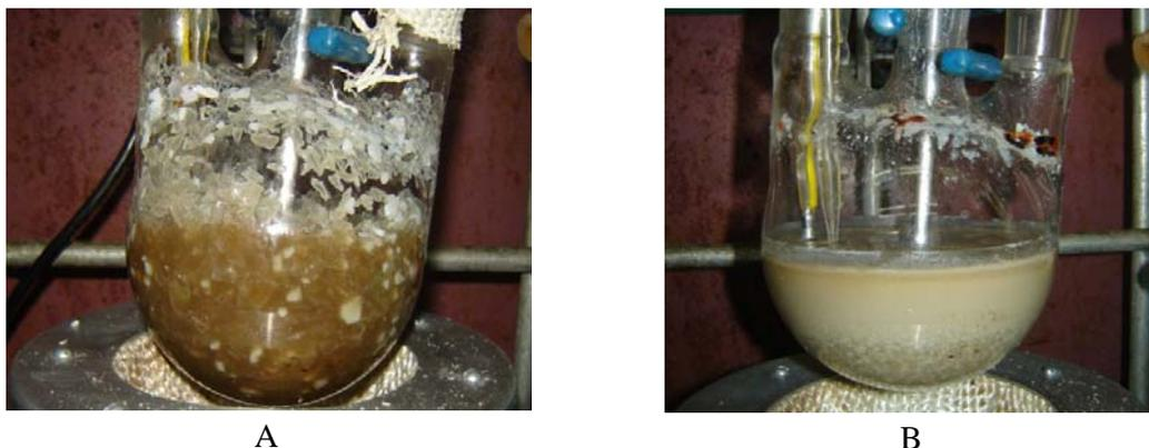
Figura 4.34. Apariencia de la mezcla antes (4.34A) y después (4.34B) del proceso de reacción del PET con [bmim]Cl como solvente y catalizador.
