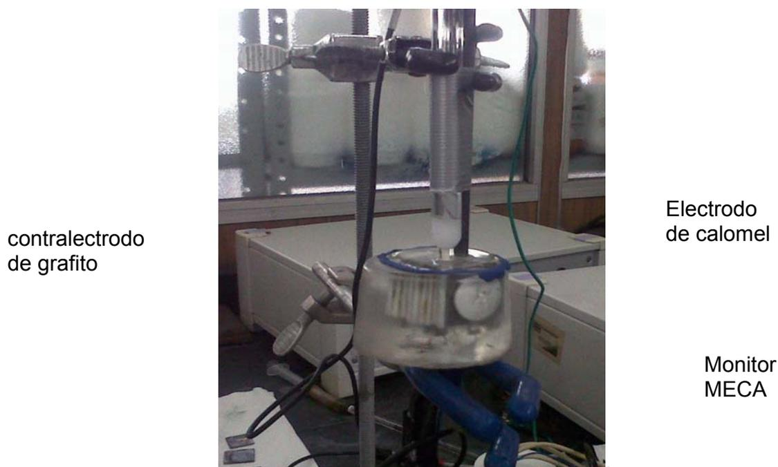
Fig. 3.12 Fotografía que muestra la forma en la que se hicieron las mediciones experimentales para curvas de polarización
