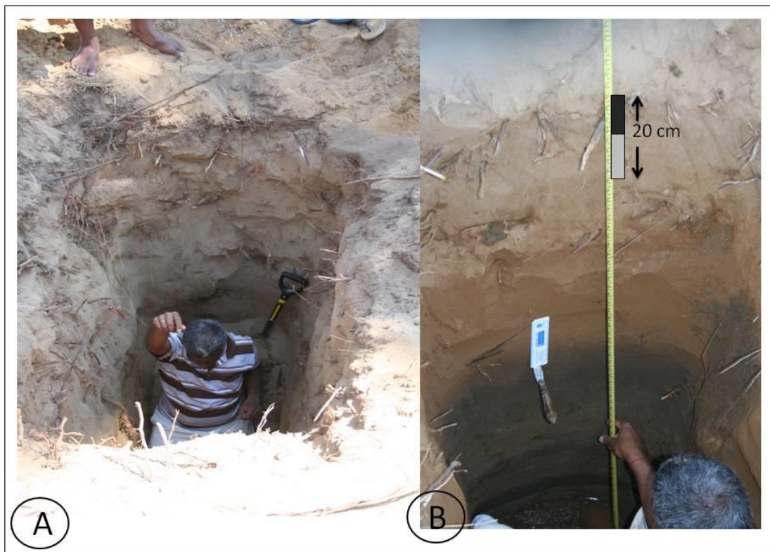
Figura 5.2 Geometría de los pozos excavados y metodología utilizada para describir las unidades estratigráficas.
