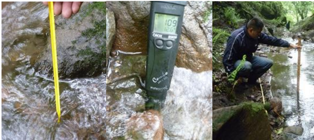
Figura 6. Medición de temperatura, conductividad eléctrica y perfil batimétrico.
