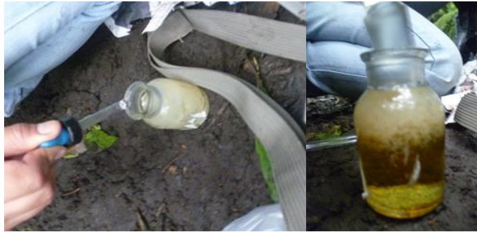
Figura 5. Toma de muestra y fijación de oxígeno disuelto.
