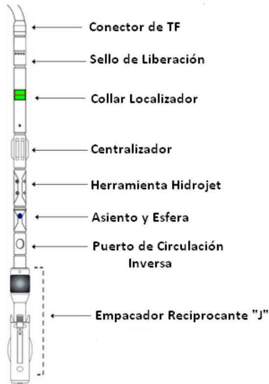
FIGURA 3.5.- Equipo de fondo del método HPAP. 18
