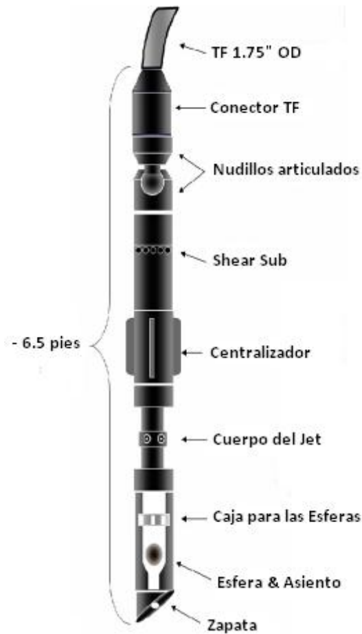
FIGURA 3.4.- Equipo de fondo del método HPAP con PPD. 11
