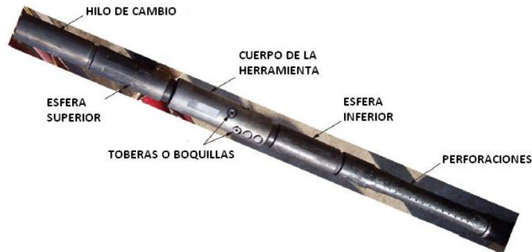
FIGURA 3.3.- Sección de una herramienta lista para entrar al pozo para un tratamiento con HJAF. 26
