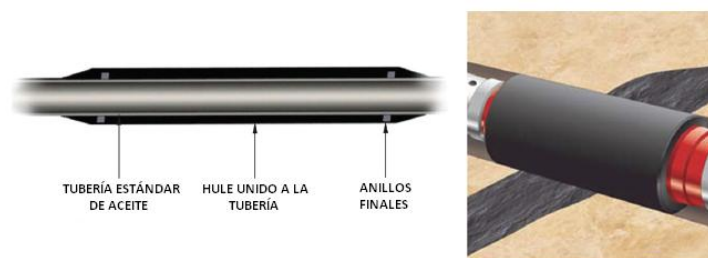
FIGURA 3.8.-. Componentes de un empacador inflable. 26
