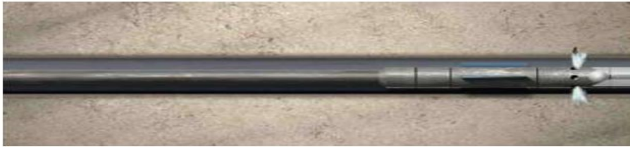
FIGURA 3.10.- Método Commuter Frac, muestra la esfera en el asiento mientras se hace la perforación de la fractura en el objetivo deseado. 26
