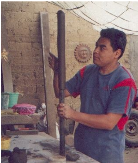
Figura 5.8 Elaboración del mango con un molde tubular de madera.
