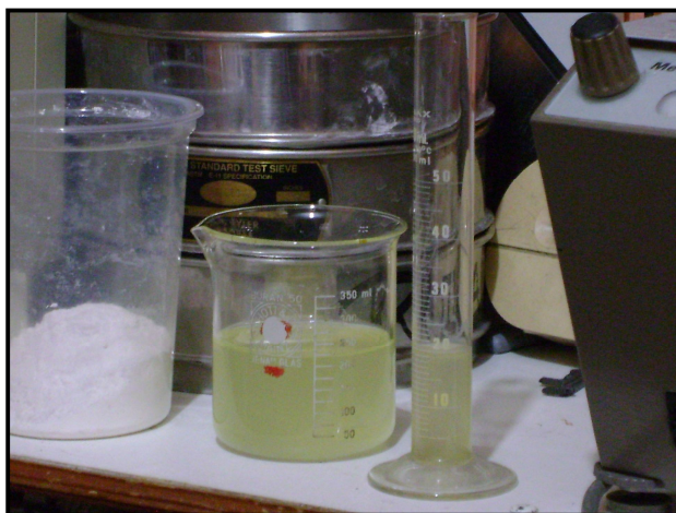
Figura 5.15 Cal lista para mezclarse con la preparación de baba de nopal,
