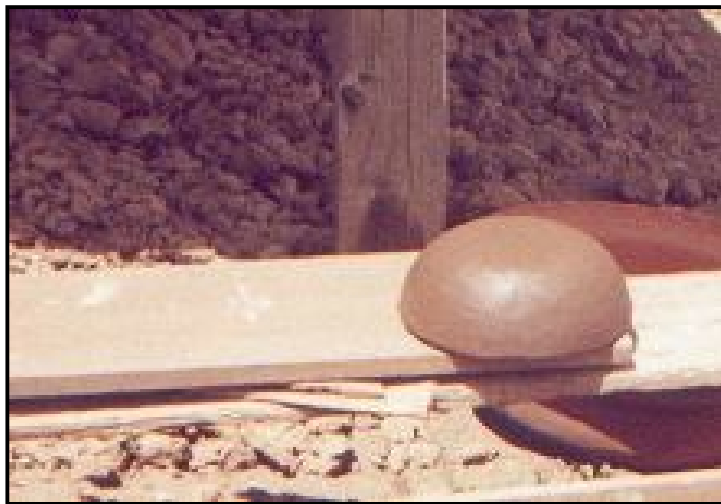
Figura 5.6 Secado directo al sol de la cazoleta, aun sobre el molde.
