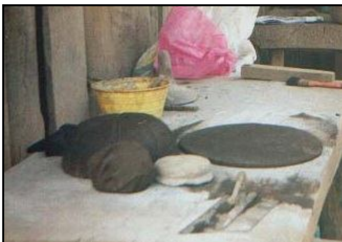
Figura 5.5 Se puede observar el disco de arcilla, el aplanador y el molde humedecido para iniciar la cazoleta.
