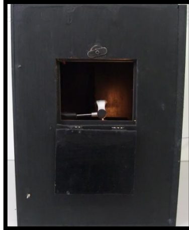
Figura 15. Caja negra para el análisis de color.
