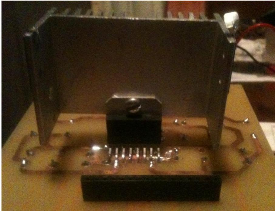
Figura D.7 pcb terminado del puente H
