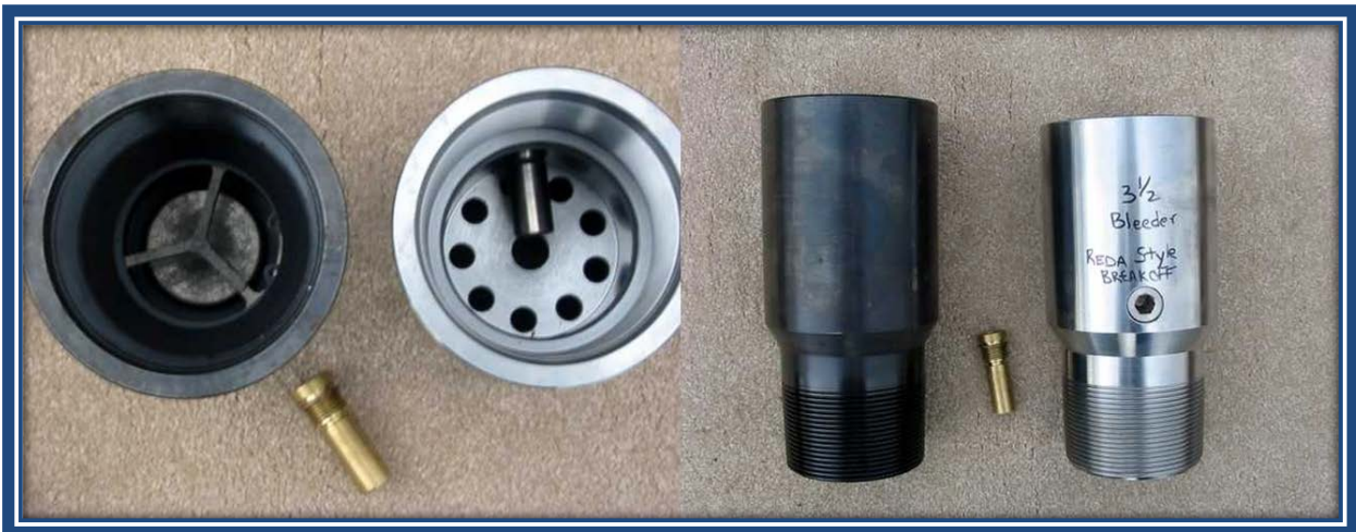
Figura II.20 Válvula de Drene.
