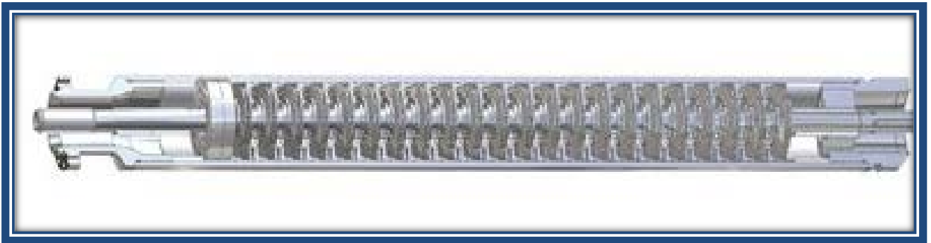
Figura II.9 Corte transversal de la Bomba Electrocentrífuga (BEC).
