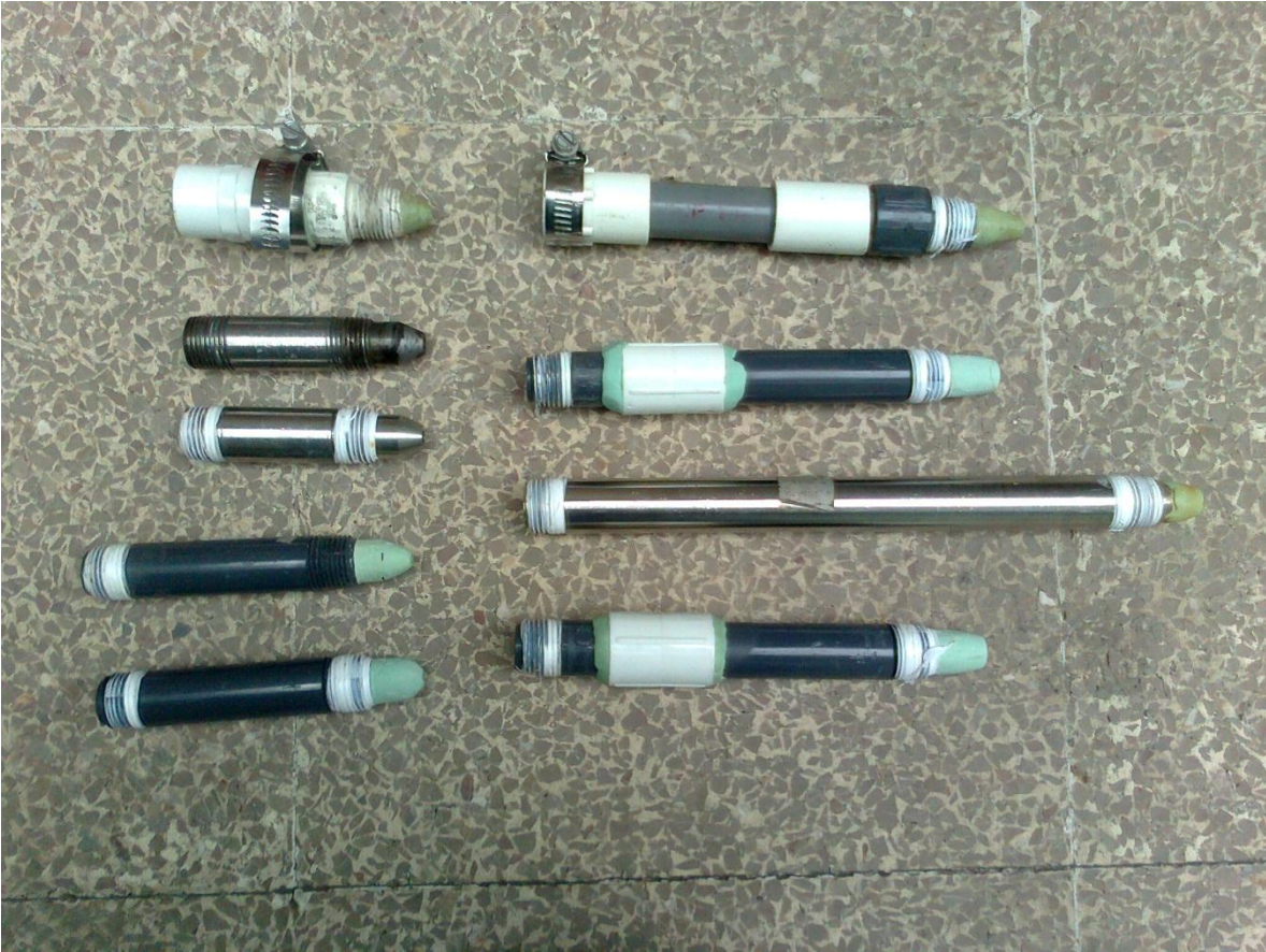
Figura 17 Fotografía de los inyectores (lado izquierdo) y difusores (lado derecho) utilizados en la experimentación
