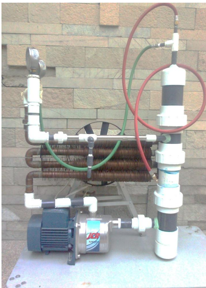
Figura 19 Prototipo de compresor por inyección después del proceso de optimización
