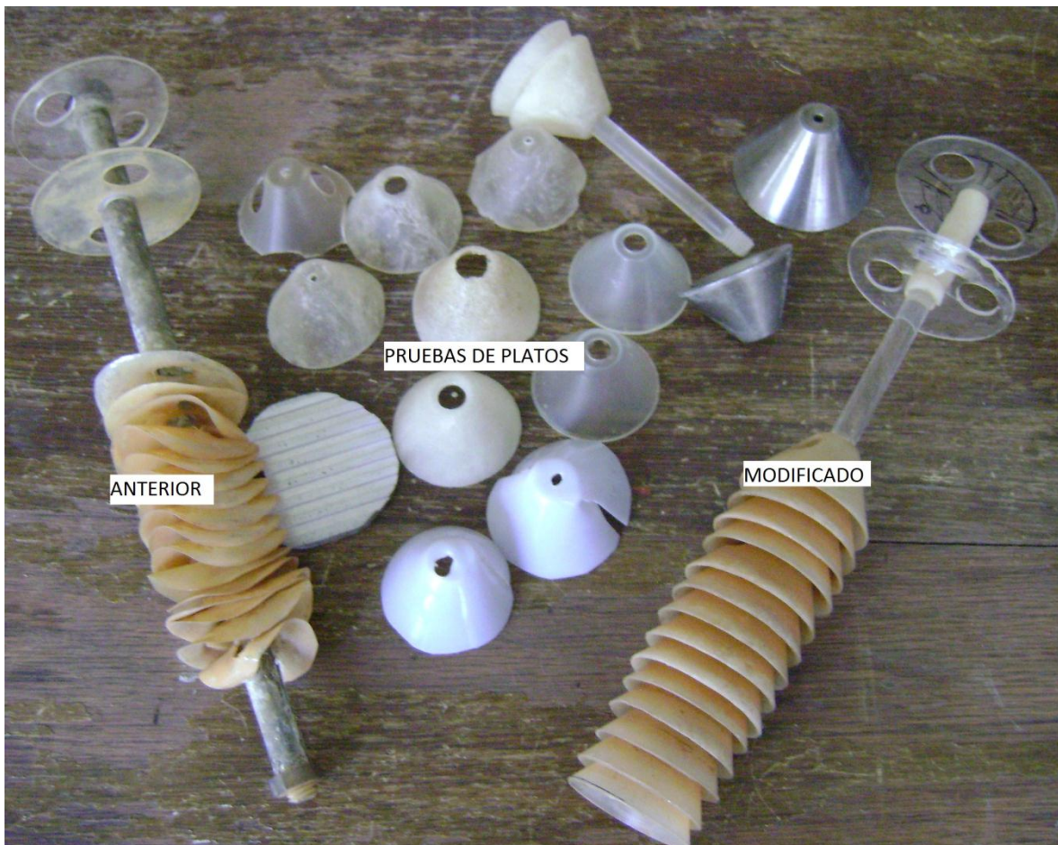
Figura 13 Mejoras al separador, se pueden apreciar depósitos de óxido en los platos, posiblemente provenientes de la bomba.
