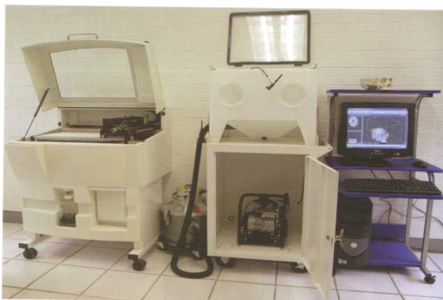
Fig. 27 Estereolitógrafo.
