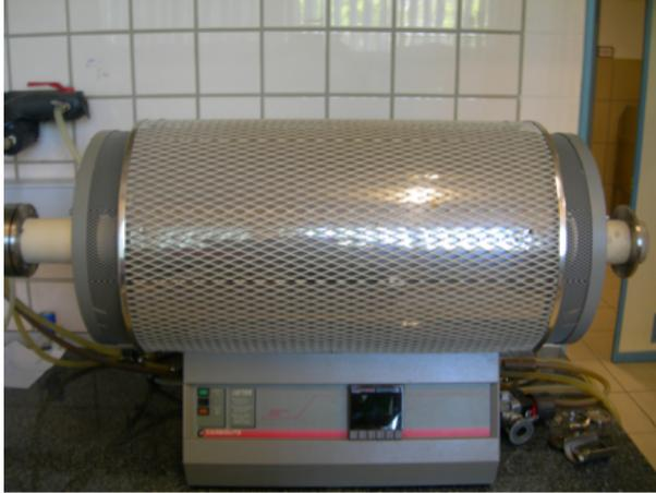
Fig.13 Horno de sinterización.
