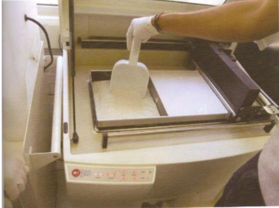
Fig. 29 Sustancias del estereolitógrafo.
