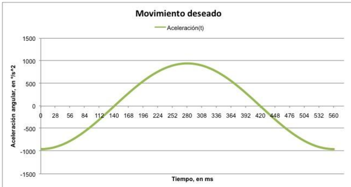
Figura 5.4 Gráfica de la aceleración en función del tiempo, del movimiento que se desea que el sistema desarrolle.
