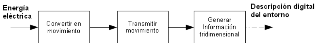
Figura 3.4 Una nueva descomposición del problema en la que se contempla la subfunción de Transmitir movimiento.
