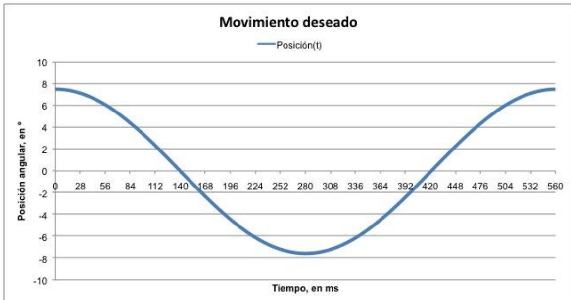
Figura 5.2 Gráfica de la posición en función del tiempo, del movimiento que se desea que el sistema desarrolle.
