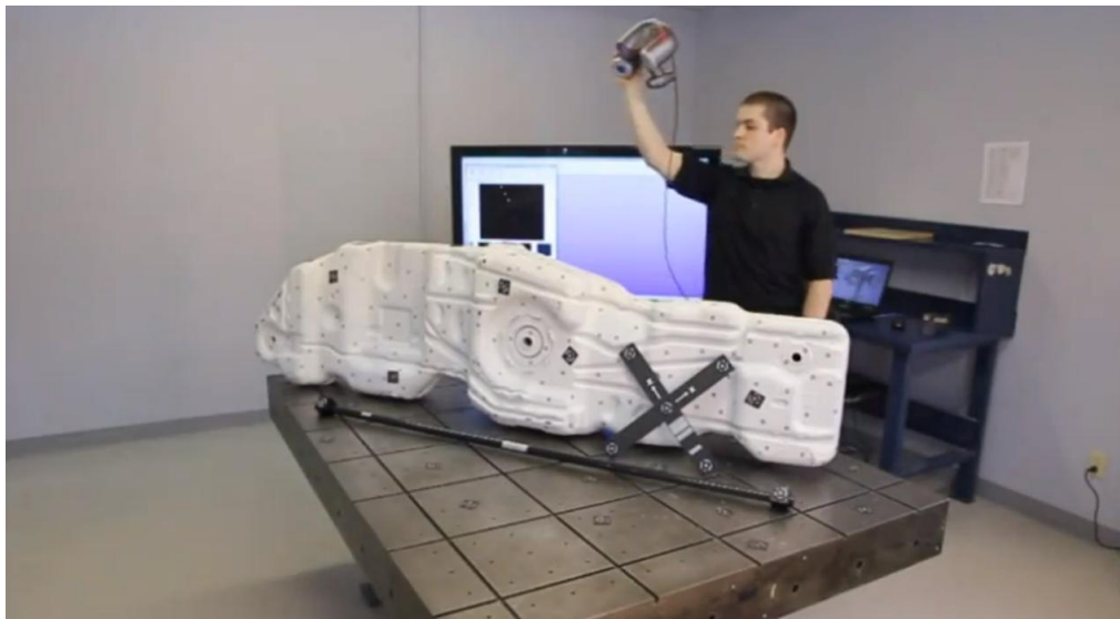
Figura 2.3 Objeto de interés con marcas de posicionamiento, barra de escala y cruz de referencia.
