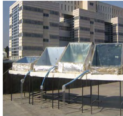
Fig. 3.11 Destilador solar pasivo con medición de proyección de sombras Fuente: Feilizadeh et al. (2010)
