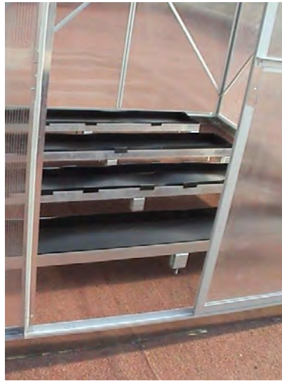
Fig. 5.5 Canaletas de agua salina o salobre, comunes a las casetas de desalinización solar
