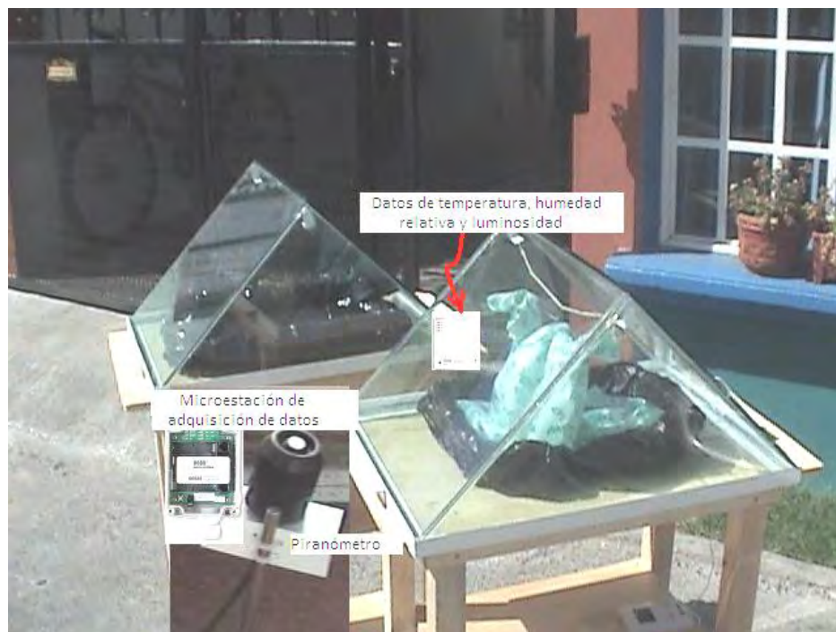
Fig. 6.1 Unidades de experimentación nivel laboratorio Material poroso: tela de algodón
