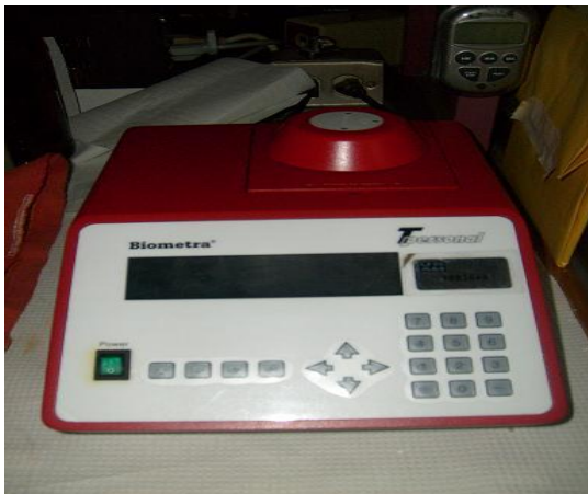
Figura 3. Termociclador Biometra el cual se puede programar para controlar la temperatura y el tiempo de reacción
