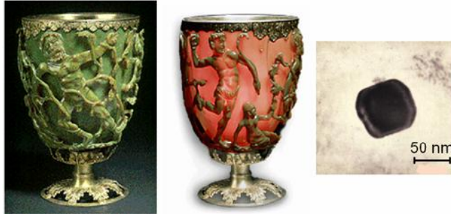
Figura 1.1 Copa de Lycurgus iluminada desde el exterior (izquierda), desde el interior (centro) e imagen de microscopio electrónico de una nanopartícula de oro encontrada en el vidrio del que está hecho (derecha).
