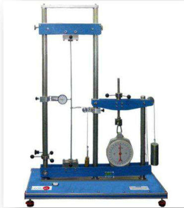
Figura 1.10. Equipo universal de pandeo MUP EDIBON. [17]
