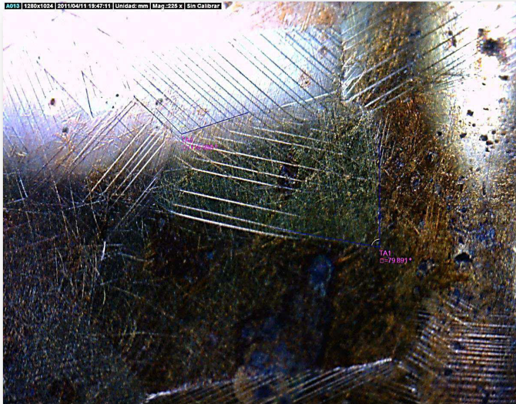
Figura 3.25. Micrografía de M.M.F. a 225X con ubicación de ángulo de variante de transformación.
