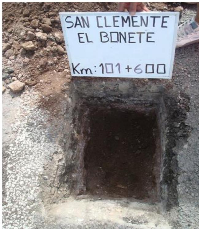
**VISTA DEL SONDEO DE PAVIMENTO EN EL KILÓMETRO 101+600, EN EL CUAL SE OBSERVA LA ESTRATIGRAFÍA QUE PRESENTA LA ESTRUCTURA DEL CUERPO ACTUAL.**
