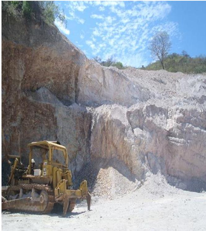
**VISTA DEL BANCO DE TERRACERIAS "LA CAJETA" UBICADO EN EL KILÓMETRO 101+600 DESVIACION ATRAS CON 600 mts. EN LA CUAL SE OBSERVA EL TIPO DE MATERIAL GRAVA ARCILLOSA CON ARENA EXISTENTE EN DICHO BANCO.**
