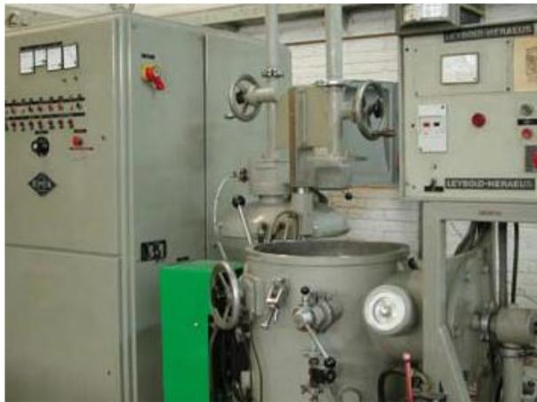
Figura 3.1 Horno de inducción con atmosfera controlada. [36]
