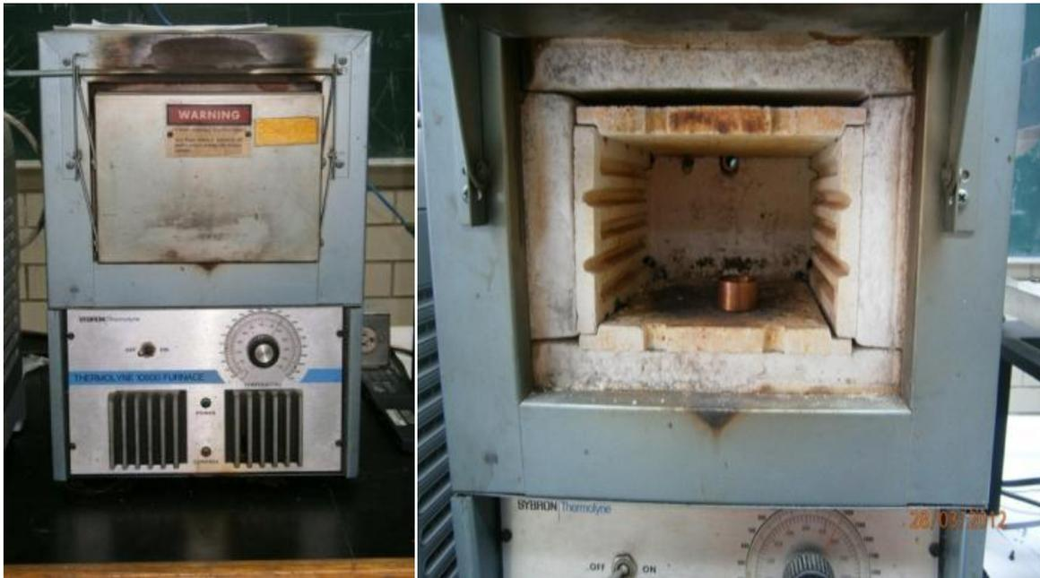
Figura 3.8. Mufla utilizada para el tratamiento térmico del Laboratorio de Mecánica Aplicada Fes Aragón.
