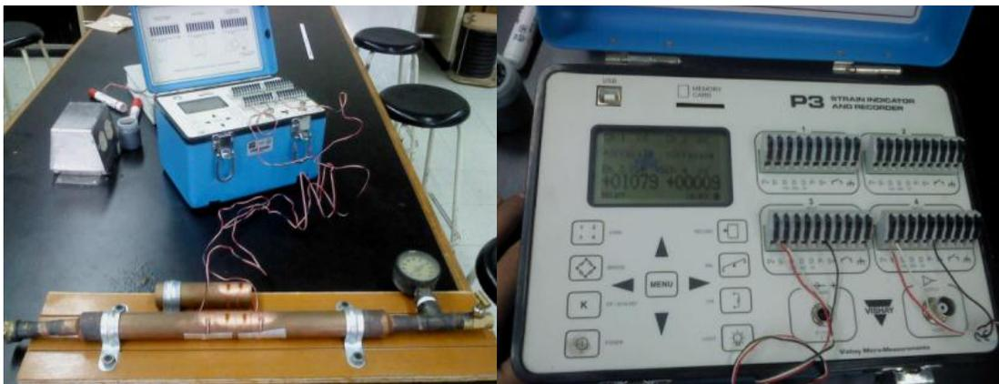
Figura 2.10. Arreglo de extensómetros conectados.
