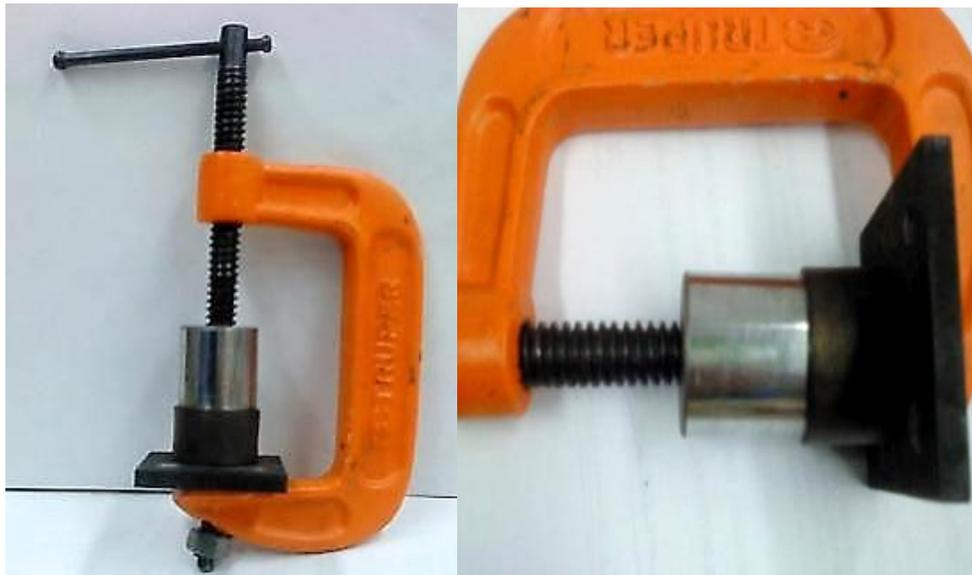
Figura 3.11. Prensa para introducir el avellanador en el cople.
