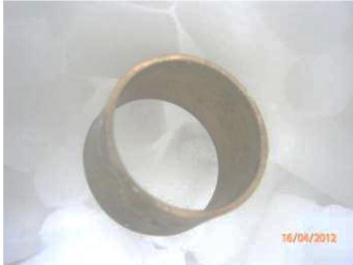
Figura 3.10. Cople con memoria de forma introducido en hielo seco.
