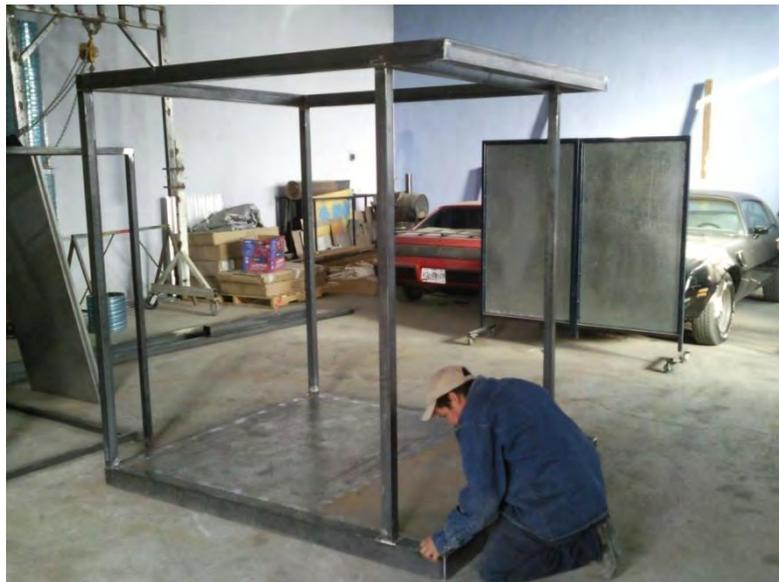
Colocando placa piso lamina negra cal. 16. Se utilizó para unir los materiales varilla recubierta A.W.S. E 6013 de  $\varnothing$  1/8" para acero de bajo carbón marca Infra.
