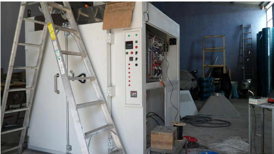
6. Terminando de conectar los componentes y realizando pruebas de funcionamiento.
