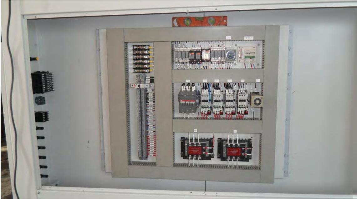
3. Se instala el tablero de control y de fuerza, en la parte lateral izquierda del horno.
