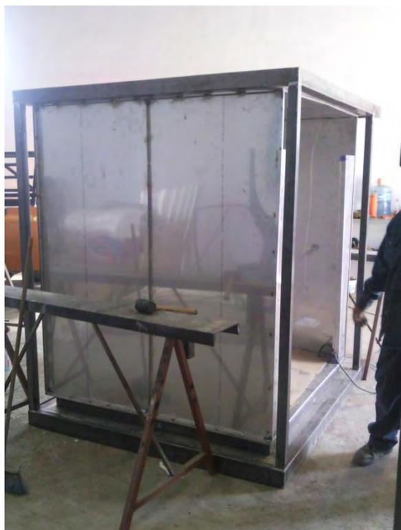
Se coloca la cavidad del horno de acero inoxidable con la estructura metálica de acero al carbón.
