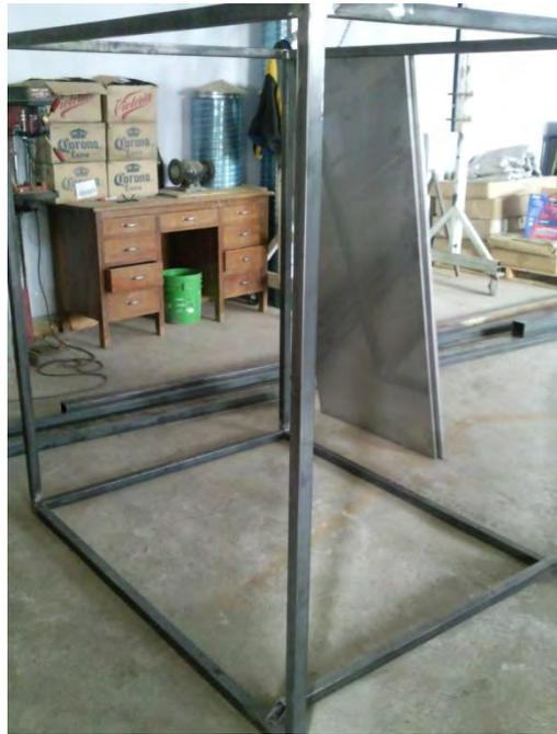
Estructura base del horno con estructura tipo cuadro PTR 2" y 4".
