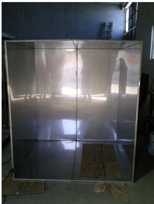
Se realiza la fabricación del cuerpo interno del horno en lámina acero inoxidable 304 - 2B se utiliza soldadura con varilla recubierta A.W.S. E 308 L-16 de Ø 1/8" marca Infra.
