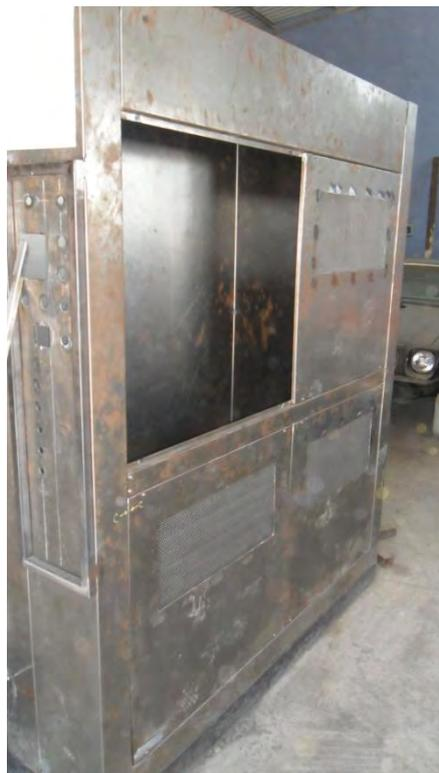
Se colocan las guardas y perforaciones donde posteriormente se utilizaran para colocacion del tablero de control y fuerza.
