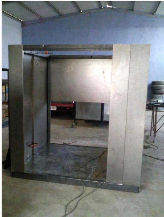
Se colocan las laminas negras exteriores, ASTM A-36 cal. 16
