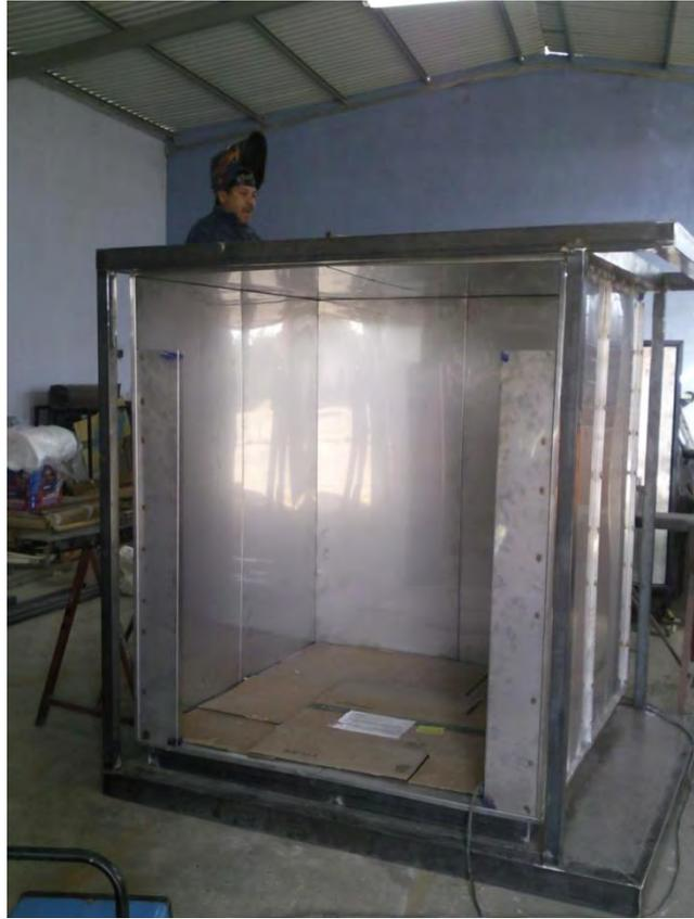
Para la unión se utiliza varilla recubierta A.W.S. E16 H-16
