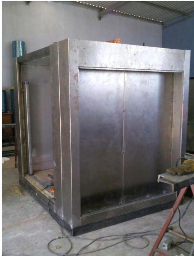
Se terminan de soldar las ultimas tapas de làmina negra para cubrir el horno.
