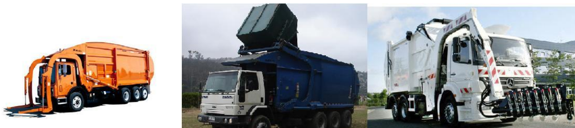
Figura 7 Vehículos de carga frontal
