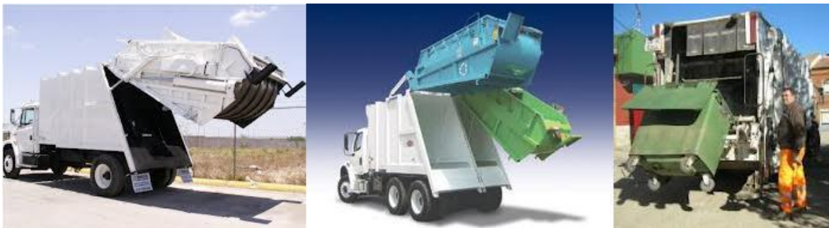
Figura 5 Vehículos de carga trasera
