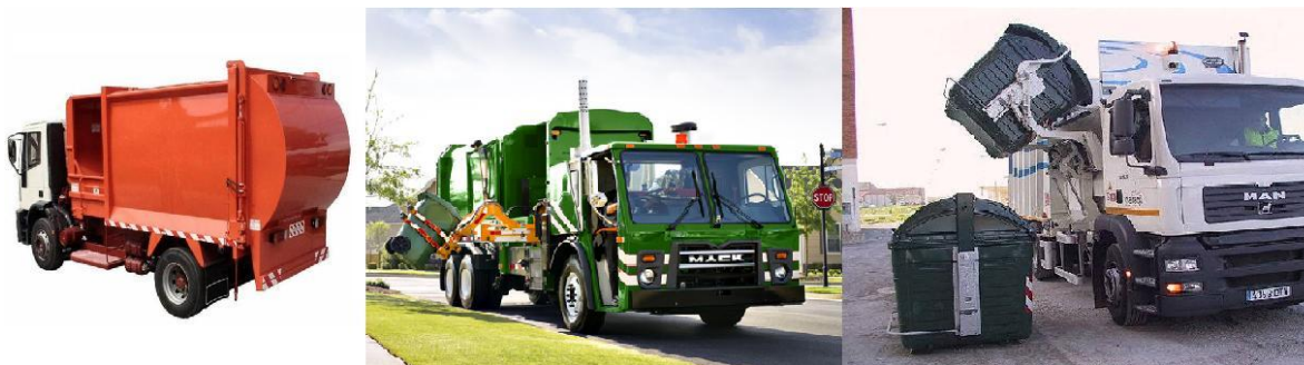
Figura 6 Vehículos de carga lateral
