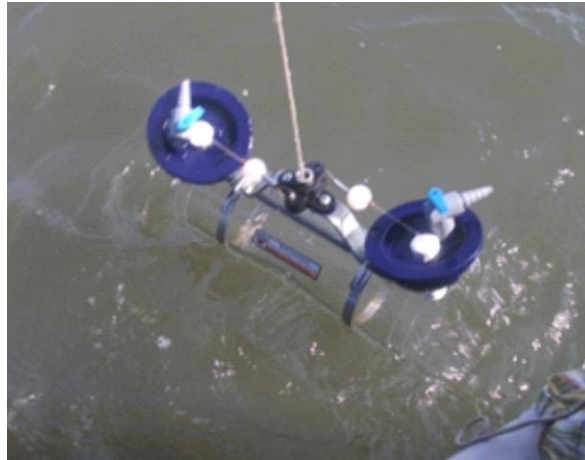
Fig. 11. Botella de Van Dorn para características hidrológicas de fondo.
