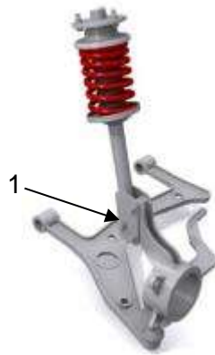
Figura 1.13. Suspensión McPherson (Longhurst, 2012).
