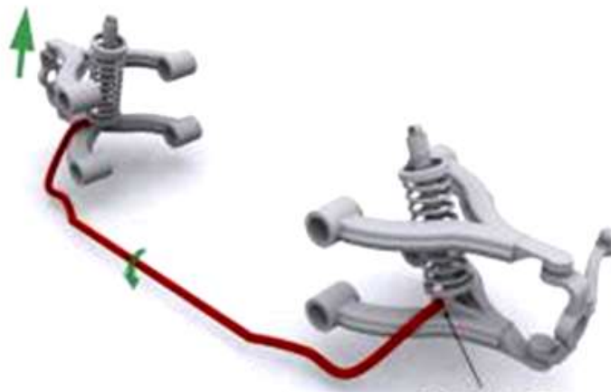
Figura 1.4. Funcionamiento barra estabilizadora (Longhurst, 2012)
