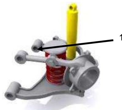
Figura 1.16. Suspensión multibrazo (Longhurst, 2012)
