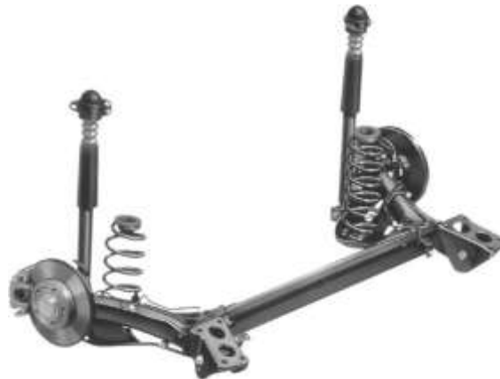
Figura 1.23. Suspensión de eje semi-rígido del VW Golf®, VW Bora® y Audi® A3 (Crolla, 2009)
