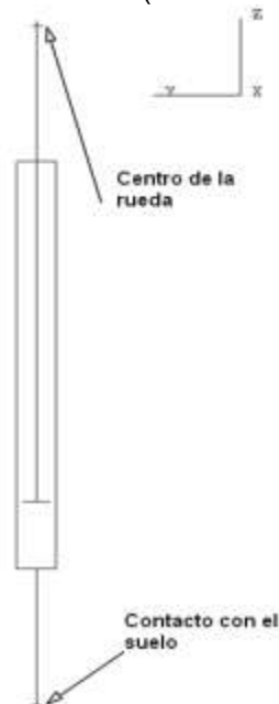
Figura 2.21 Modelo simple de la llanta (Hellman, 2008)
