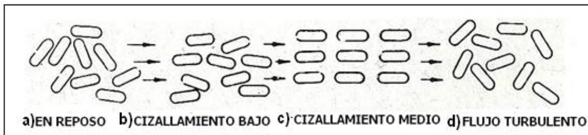
Figura 1.17. Cambios estructurales que sufren los materiales fluidificantes (Glicksman, 1969).
