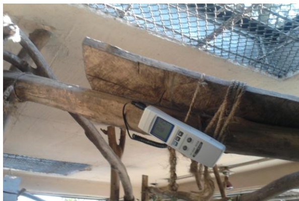
Fig. 26. Modo de colocación del radiómetro para la toma de las lecturas
