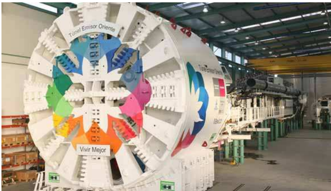
Figura 1 . Vista del escudo EPB S-497, a emplear para la construcción del tramo I ( http://www.herrenknecht.com/news/press-section/mexico-city-is-prepared-to-build-the-largest-wastewater-system-worldwide.html , 2009)
