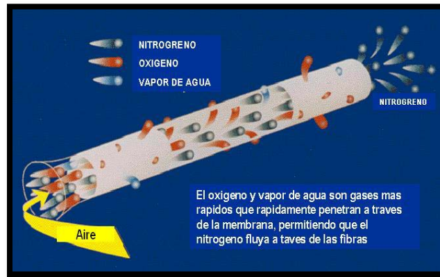
Figura 2.3- Proceso de separación del Nitrógeno del aire por medio de una membrana.
