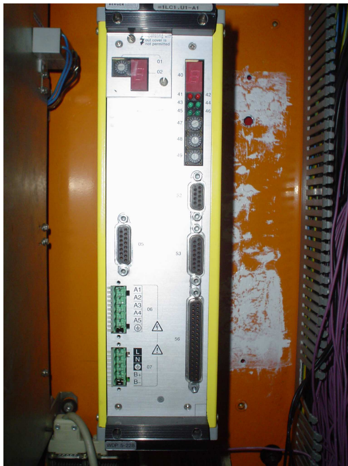
Figura 3.3 Controlador WDP 5-228 empleado para mover los motores encontrados en la máquina CNC EMCO Ls140.
