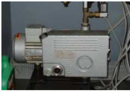
(a) Bomba de vacío
