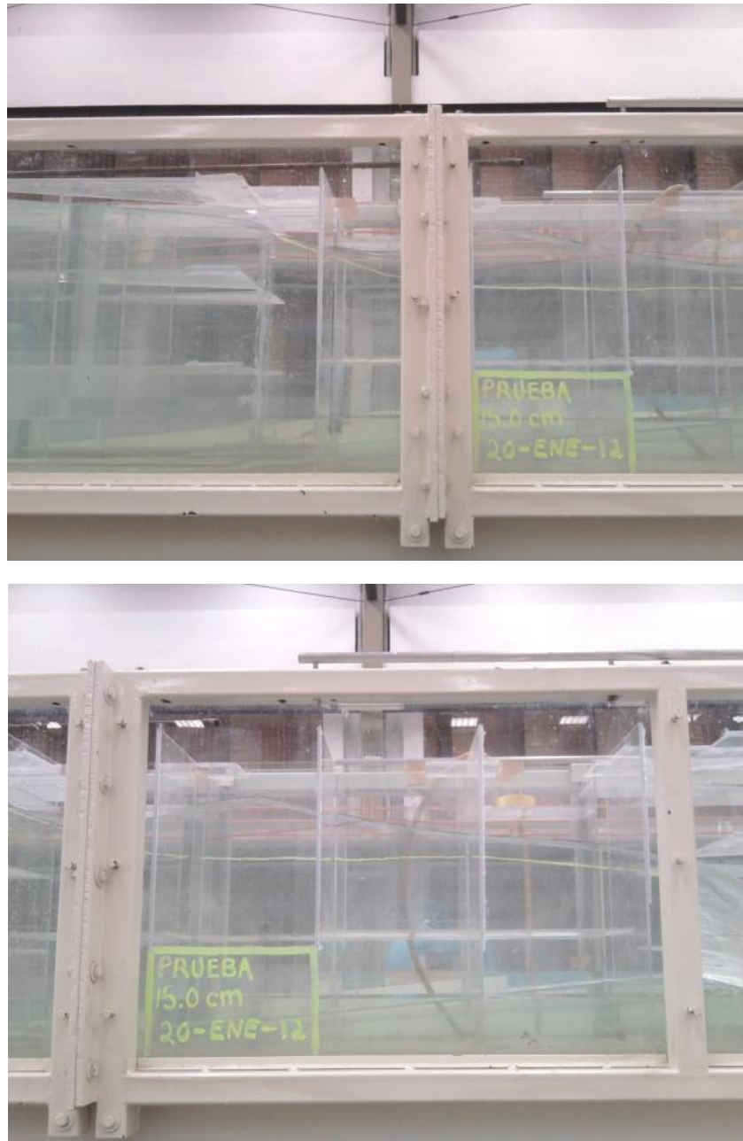
Imagen 7. Perfil de flujo del Prototipo No.2, con rampa de variación de altura igual a 15 cm, instalado canal de prueba.
