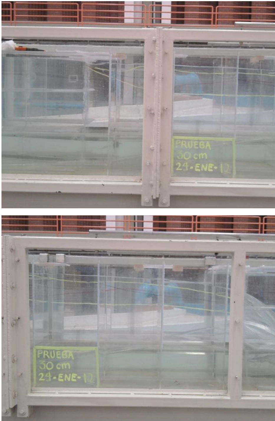
Imagen 9. Perfil de flujo del Prototipo No. 2, con rampa de variación de altura igual a 30 cm, instalado canal de prueba.
