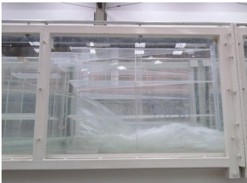
Imagen 6. Perfil de flujo del Prototipo No.2, con rampa de variación de altura igual a 10 cm, instalado canal de prueba.
