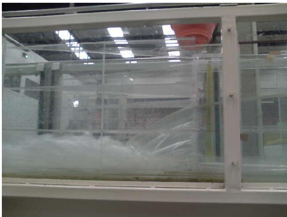
Imagen 4. Perfil de flujo del Prototipo No.2, con rampa de variación de altura igual a 5 cm, instalado canal de prueba.
