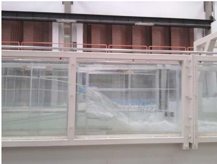
Imagen 8. Perfil de flujo del Prototipo No.2, con rampa de variación de altura igual a 20 cm, instalado canal de prueba.
